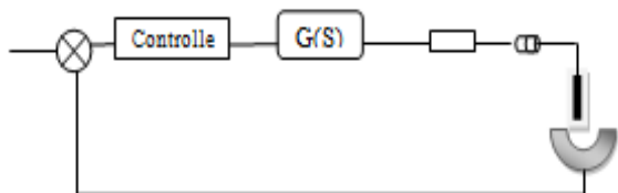
شکل (۵): دیاگرام بلوکی سیستم کنترل الکترودهای کوره قوس الکتریکی اگر بلوک شکل (۵) را به صورت شکل (۶) در نظر بگیریم، می توان G(s) را به صورت رابطه (۸) در نظر گرفت.
