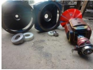
شکل ۹: نحوه عایق سازی یاتاقانهای ژنراتور
