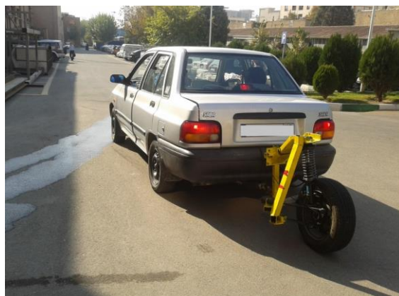
شکل ۴: خودروی آزمون به همراه چرخ پنجم
