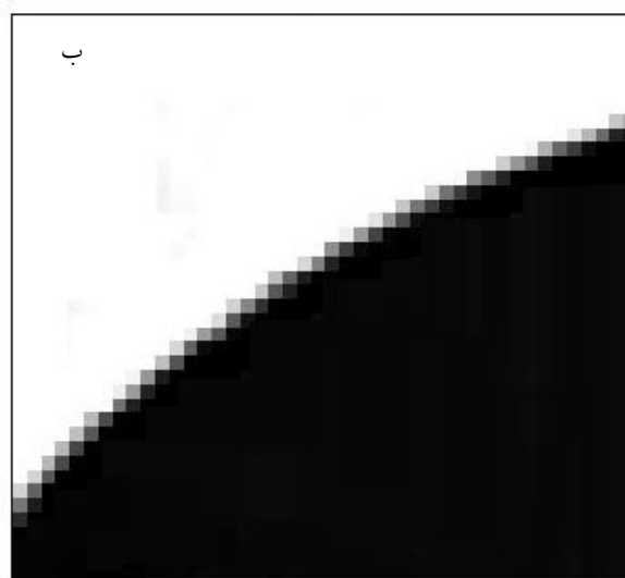
شکل ۲ (الف-۲) قسمتی از لبه قطره از تصویر اصلی (ب-۲) تصویر بعد از تیز کردن لبه
