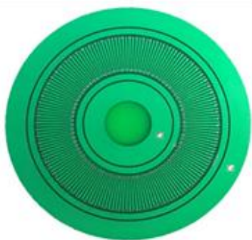
شکل ۳: شکل شماتیک انکودر خازنی دورانی طراحی شده
