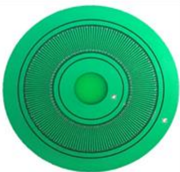
شکل ۳: شکل شماتیک انکودر خازنی دورانی طراحی شده
