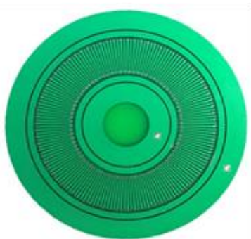
شکل ۳: شکل شماتیک انکودر خازنی دورانی طراحی شده
