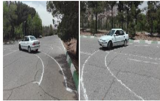
شکل ۱: آزمایشات عملی دورزدن تک‌فرمان با خودروی سمند
