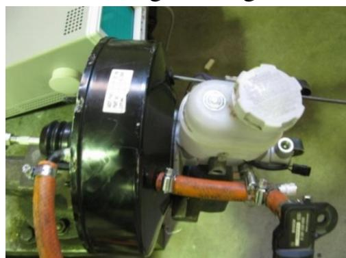
شکل ۱۸: بوستر ترمز مجهز به ادوات اندازه گیری
