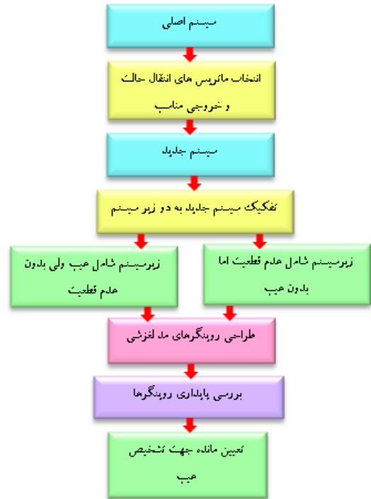
شکل ۱: ساختار تشخیص عیب سنسوری به روش پیشنهادی
