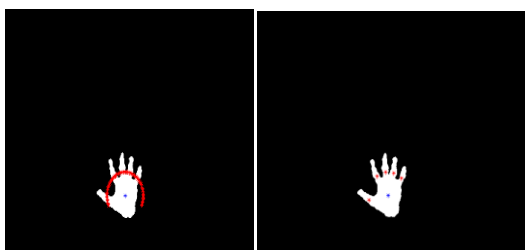
شکل ۱۳) توصیفگر دایروی: نمایش مرکز و نماینده هر انگشت در تصویر جداسازی شده دست
