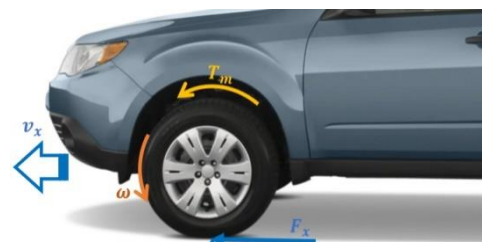
شکل ۱: دیاگرام جسم آزاد مدل یک چهارم خودرو در فرآیند شتاب‌گیری
