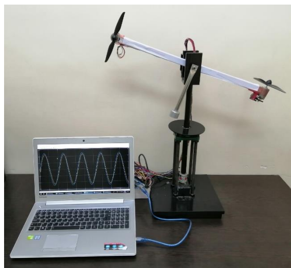
شکل ۲: ساخت سیستم واقعی TRMS در محیط آزمایشگاهی
