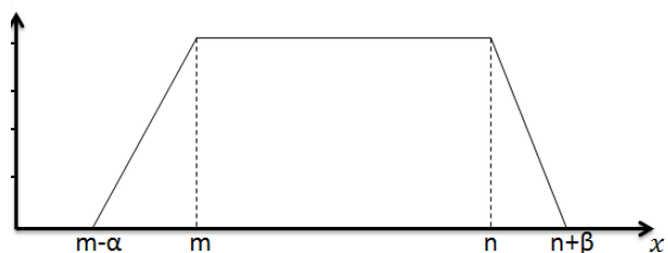
شکل ۴: شمای کلی عدد فازی دوزنقه‌ای.
