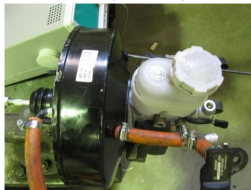
شکل ۱۸: بوستر ترمز مجهز به ادوات اندازه گیری
