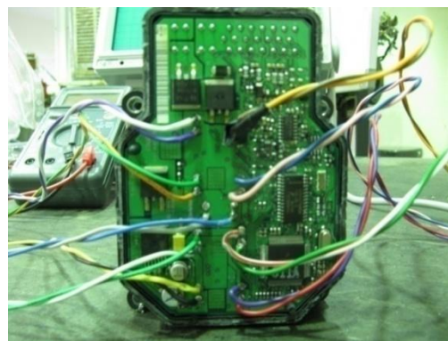
شکل ۱۷: بلوک سیستم ترمز ضد قفل مجهز به سیم های دریافت سیگنال
