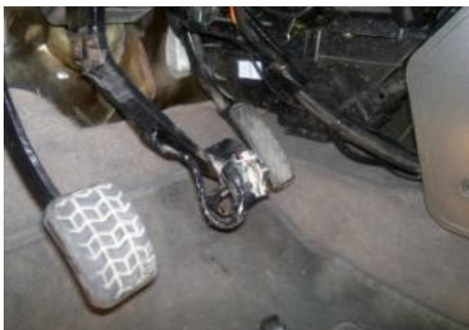
شکل ۱۹: نیروسنج نصب شده بر روی پدال ترمز
