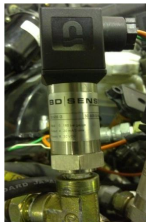
شکل ۱۶: سنسور فشارسنج هیدرولیک
