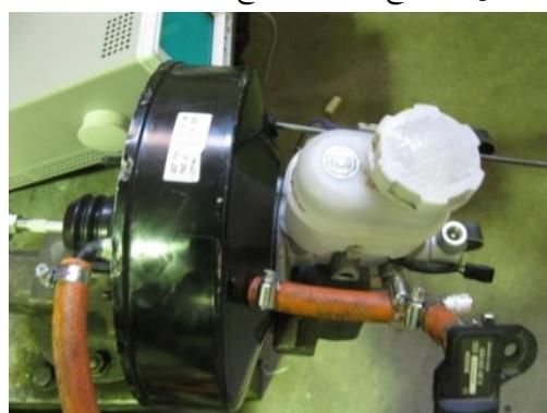
شکل ۱۸: بوستر ترمز مجهر به ادوات اندازه گیری
