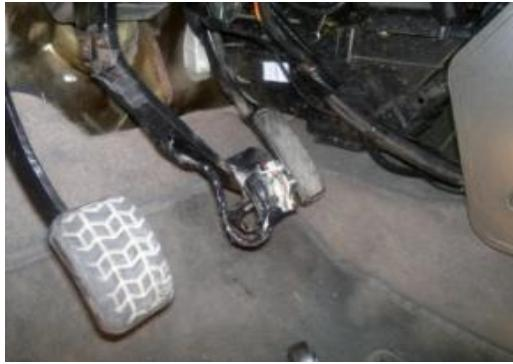
شکل ۱۹: نیروسنج نصب شده بر روی پدال ترمز
