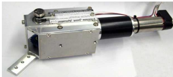
شکل ۲: نمای بیرونی یک عملگر الاستیکی چرخشی [۱۵]
