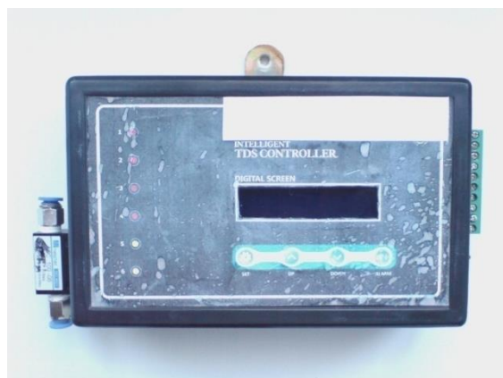
شکل ۲۰: نمای کلی از سیستم اندازه گیری و کنترل TDS طراحی و ساخته شده
