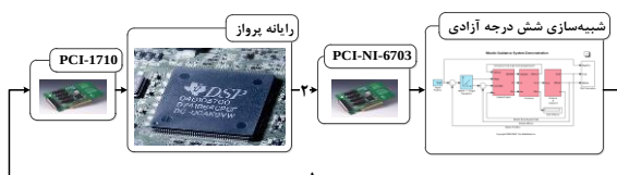
شکل ۹- دیاگرام بلوکی آزمون سخت‌افزار در حلقه [۱]
