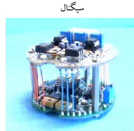
شکل ۱۰- سخت‌افزار نهایی قرار داده شده در آزمون سخت‌افزار در حلقه
