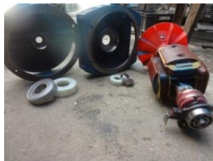
شکل ۹: نحوه عایق سازی یاتاقانهای ژنراتور
