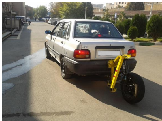
شکل ۴: خودروی آزمون به همراه چرخ پنجم
