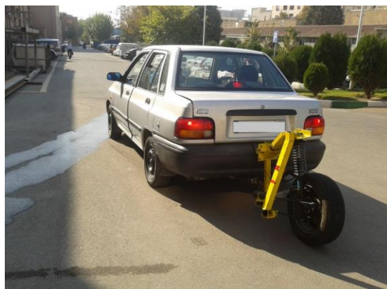
شکل ۴: خودروی آزمون به همراه چرخ پنجم
