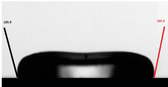
شکل ۸ تصویر برخورد قطره گلیسرین با سطح استیل [۱۲]
