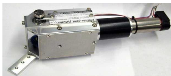
شکل ۲: نمای بیرونی یک عملگر الاستیکی چرخشی [۱۵]
