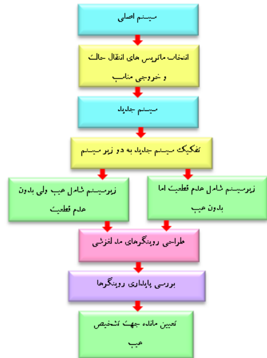
شکل ۱: ساختار تشخیص عیب سنسوری به روش پیشنهادی
