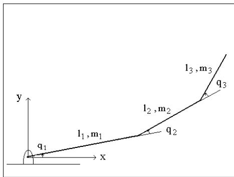
شکل ۲- شماتیک یک ربات سه درجه آزادی صفحه‌ای
