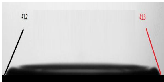
شکل ۷ تصویر برخورد قطره اتانول با سطح استیل [۱۲]
