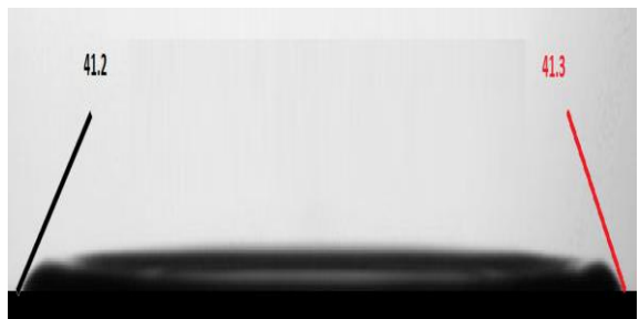
شکل ۷ تصویر برخورد قطره اتانول با سطح استیل [۱۲]
