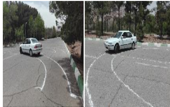
شکل ۱: آزمایشات عملی دورزدن تک‌فرمان با خودروی سمند
