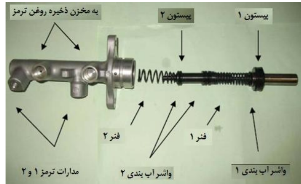
شکل ۷: اجزا داخلی سیلندر اصلی [6]
