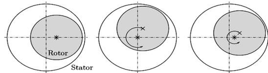
الف: گریز از مرکز مختلط، ب: گریز از مرکز دینامیکی، ج: گریز از مرکز استاتیکی
