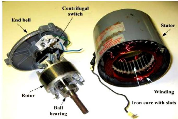
شکل ۲: ساختار داخلی یک موتور القایی سه فاز
