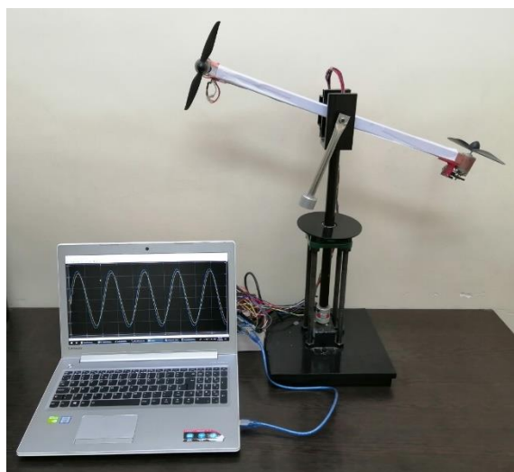
شکل ۲: ساخت سیستم واقعی TRMS در محیط آزمایشگاهی
