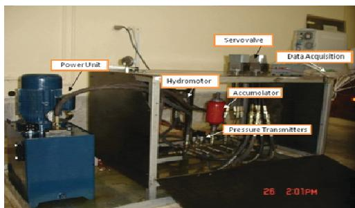
شکل ۵: چیدمان تجهیزات تست سیستم سرو‌هیدرولیک
