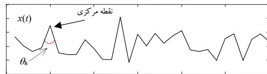
شکل (۱) : سیگنال تک بعدی نمونه، یک نقطه مرکزی و دو نقطه همسایه اش که تشكیل یک زاویه می دهد.
